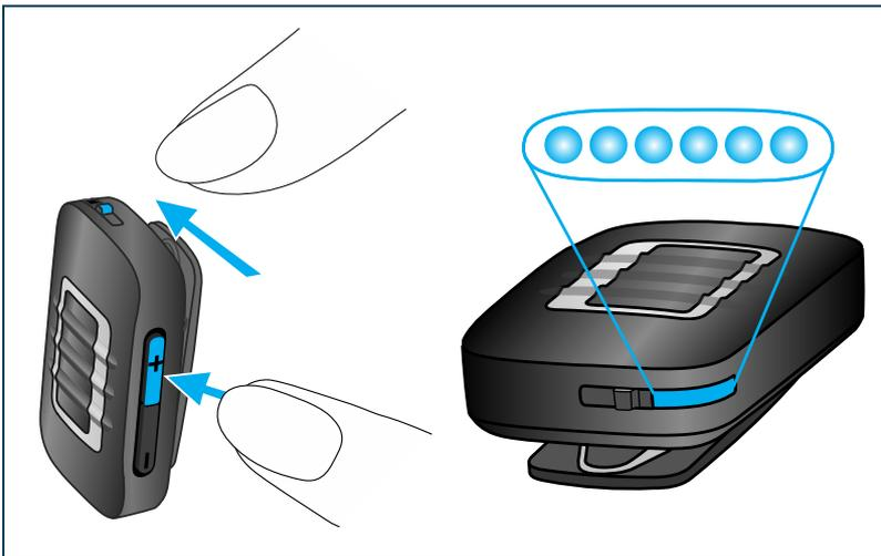
Disattivare uStream. Mantenere premuto il tasto (+) del controllo volume e attivare uStream. Quando il led **Blu** inizia a lampeggiare, uStream è pronto per l'abbinamento con un altro dispositivo Bluetooth. Se richiesto, inserire il codice di abbinamento 0000.
