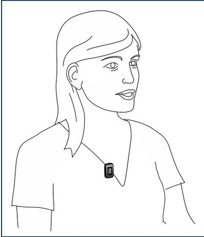
Si raccomanda di fissare uStream ai vostri abiti ad una distanza ottimale di 20 cm. La funzionalità è garantita fino a 40 cm di distanza.
