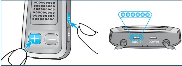
Mantenere premuti contemporaneamente il tasto (+) del controllo volume e il pulsante Connetti (<>) per 2 secondi. Quando la luce **Blu** in prossimità del connettore del collarino comincia a lampeggiare, significa che uDirect 3 è pronto per essere abbinato ad un altro dispositivo Bluetooth®.
