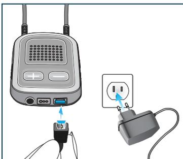
**Ricarica batterie:** Collegare il cavo USB alla parte inferiore di uDirect 3 per caricare le batterie. Generalmente sono necessari 90 minuti o meno per ricaricare completamente la batteria in base alla carica residua.
